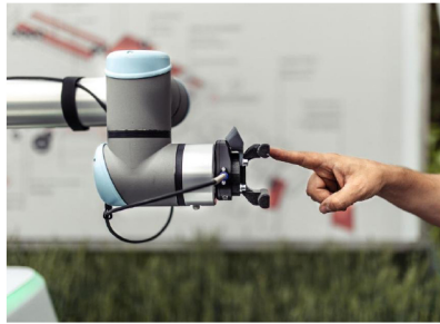
■ Zum Aufnehmen des Abfallbehälters entwickelte LCM einen Adapter ohne potenziell gefährliche bewegliche Teile.
