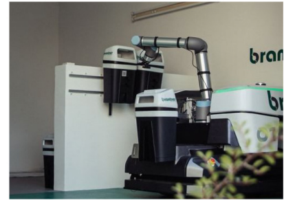
■ In der Basis erfolgen Entleerung, Reinigung und Kontrolle der Behälter, während der Roboter seine Akkuladung ergänzt.
