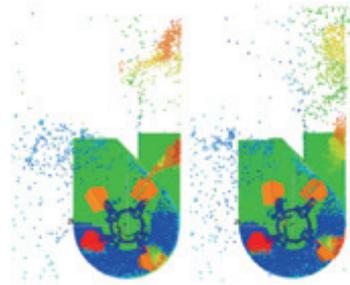
▲ Simulation des patentierten Schleuderrades im Einsatz mittels der von LCM entwickelten Software HOTINT
