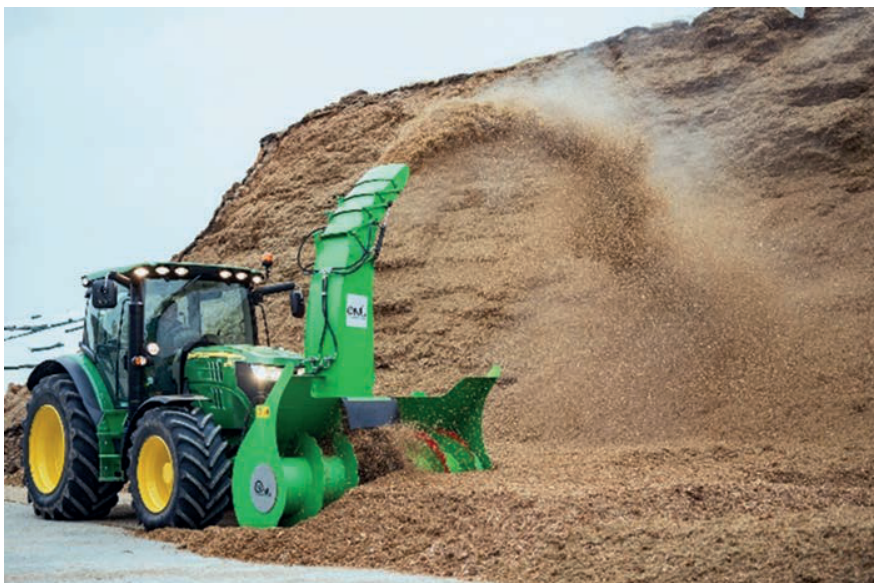
Das patentierte Schleuderrad im Einsatz
