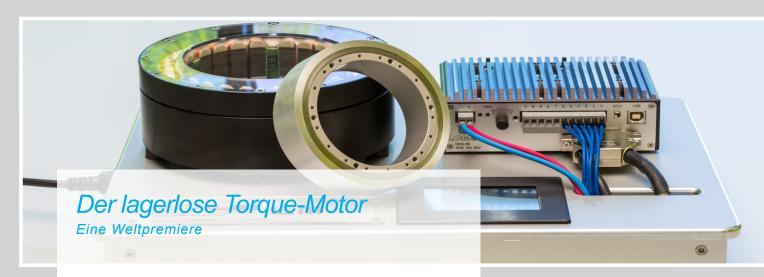
Langsamdrehende Direktantriebe für höchste Drehmomente machen Getriebe überflüssig und erobern immer neue Einsatzgebiete, ob in Windkraftanlagen oder als Industrieantriebe. Verluste und Verschleiß treten nicht nur in Getrieben auf, sondern auch in mechanischen Lagern. Deshalb präsentiert die Linz Center of Mechatronics GmbH einen Motor für hohe Drehmomente mit integriertem Magnetlager.
