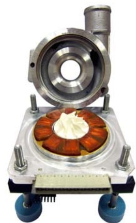
Foto 2: Mit diesem aufgebauten Prototyp konnten zahlreiche Hochgeschwindigkeitstests, etwa zur Eignung als Kompressor, durchgeführt
